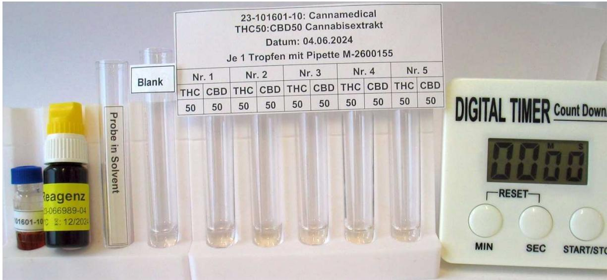
Je 1 Tropfen mit Einweg-Pasteur-Pipette (Typ 02: Pipette mit Kapillare (ratiolab® Nr. M-2600155)
