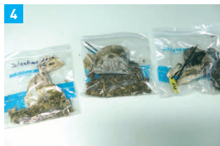
4 Genaueste Ertragsaussagen: Maissilage nach 3, 20 und 30 Vergärungstagen im BagFerm
