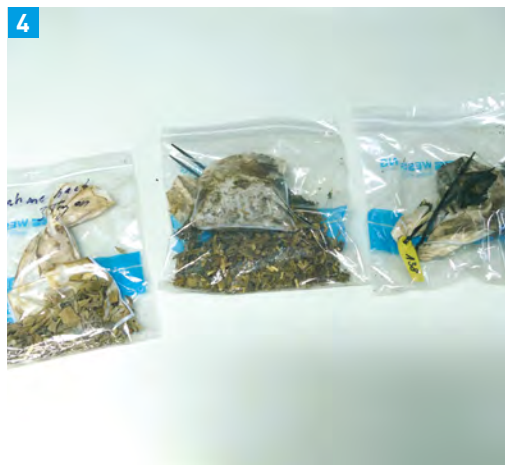
4 Genaueste Ertragsaussagen: Maissilage nach 3, 20 und 30 Vergärungstagen im BagFerm
