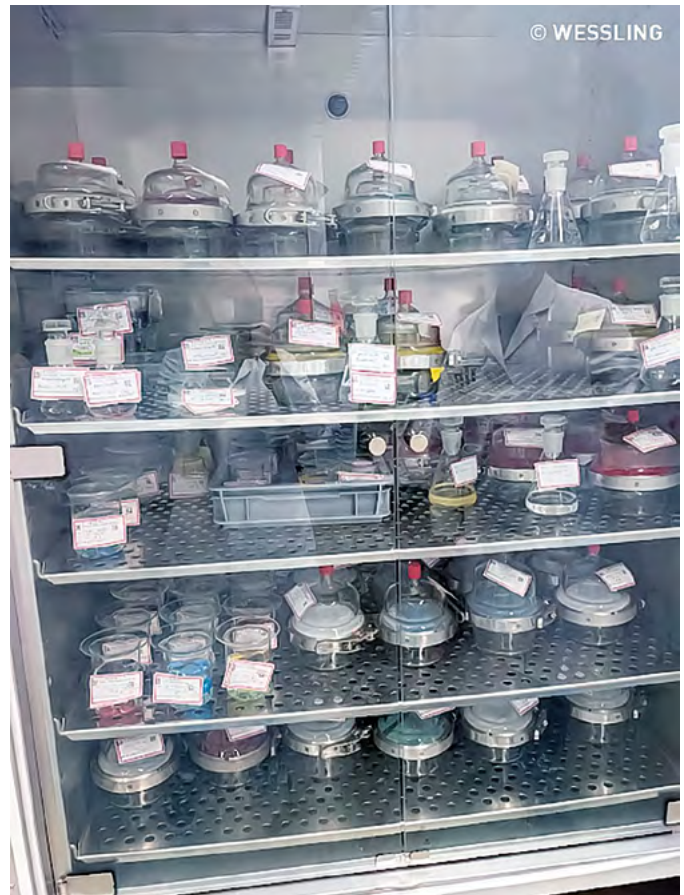
Bild 2: Migration und Lagerung bei definierter Temperatur zur Untersuchung von Bedarfsgegenständen
