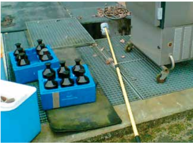
Schöpfprobenahme für Analysen in einer Kläranlage
