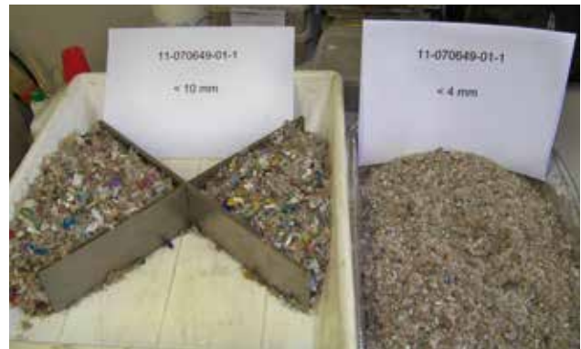
Probenzerkleinerungsstufen < 8-10 mm und < 4 mm
