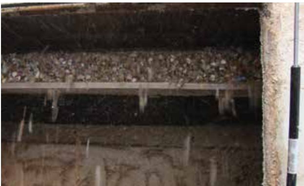
Fallstrombeprobung am Abwurf
