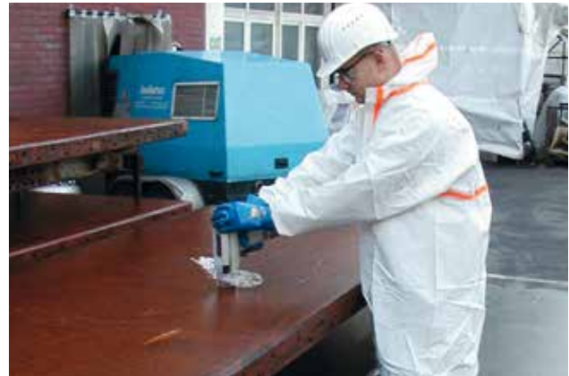
Messung des Hg-Gehalts der gereinigten Amalgamteile
