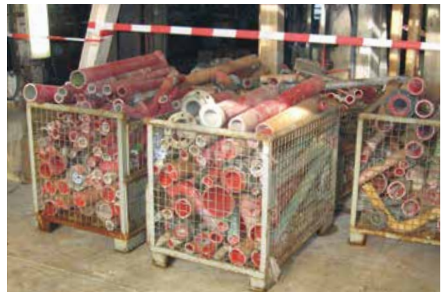
Auf Maß geschnittene Rohre zur Verpackung in 120-Liter-Fässern
